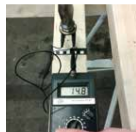
Fig. 3: Medições de umidade da madeira da estrutura após teste de estanqueidade.
